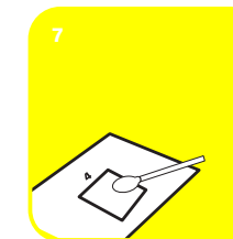
Na de vereiste contacttijd worden alle vier de velden getest met een uitstrijktest om de aanwezigheid en de hoeveelheid aan micro-organismen te meten.
