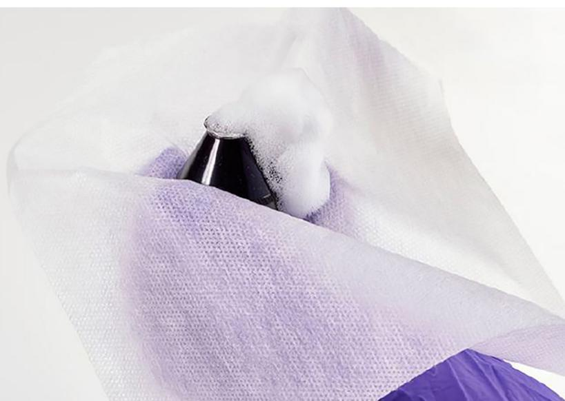
Stendere la schiuma sullo strumento in modo uniforme con la salvietta, assicurandosi che tutta la superficie ne venga in contatto. Non occorre strofinare in modo eccessivo poiché potrebbe causare il rilascio di residui di fibra dalla salvietta.
