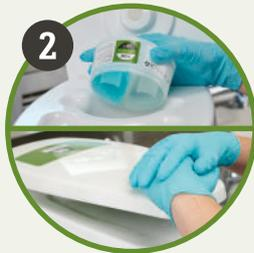
2 將一個 **POD CLO2 10<sup>+5</sup>** 消毒膠囊膠面朝下放入容器空格中，並合上蓋子使其破裂。
