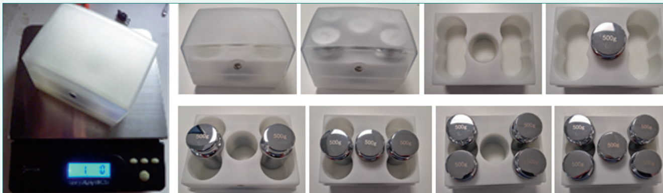
Abbildung 2. Maßgeschneiderter Gewichtssatz, von 1 kg bis 3,5 kg.
