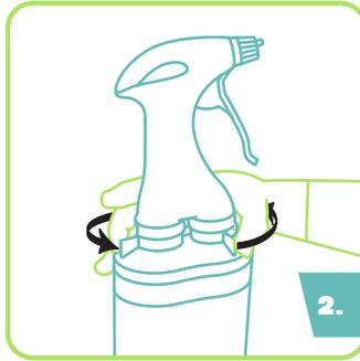
2. Serrez les leviers dans le sens inverse des aiguilles d'une montre de chaque côté du pulvérisateur pour bien le fixer.
