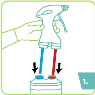
1. Pour assembler le système JET, prenez un pulvérisateur de type gâchette et repérez les indicateurs rouges et bleus sur l'étiquette du flacon ; suivez alors ces indicateurs pour insérer les tubes dans les goulots respectifs des flacons.
